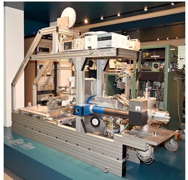
Abb. 1 Teil eines Strahlrohrs eines Mikroskops für weiche Röntgenstrahlung, das am Synchrotron BESSY in Berlin verwendet wurde und jetzt im Deutschen Röntgen-Museum in Remscheid zu sehen ist (Quelle: Archiv Deutsches Röntgen-Museum).
